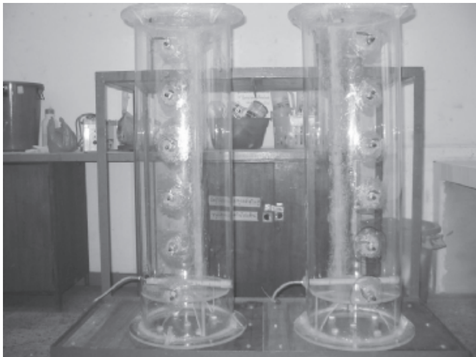
รูปที่ 1 ลักษณะระบบถังกรองไร้อากาศ
