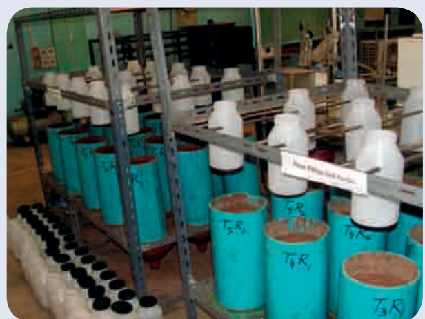
ภาพที่ 7 ภาพแสดงการทดลอง Soil leaching column
