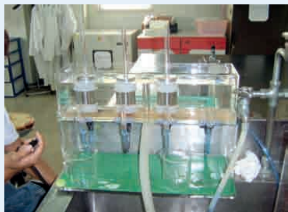
ภาพที่ 1 แสดงการหาค่าสัมประสิทธิ์การซึมผ่านน้ำด้วยเครื่อง Permeameter 4 fold type DIK - 4011
