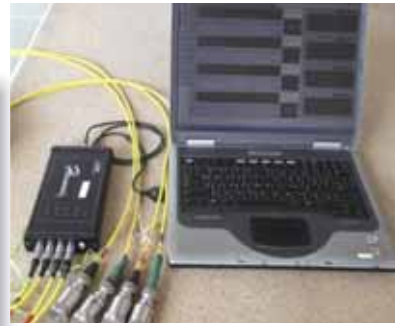
ภาพที่ 2 แสดงการปรับค่าระดับความสั่นสะเทือนก่อนเก็บข้อมูล
