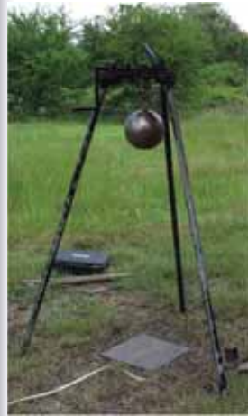
ภาพที่ 4 แสดงหัววัดความสั่นสะเทือนที่ยึดกับลิ้มและปักลงดิน
