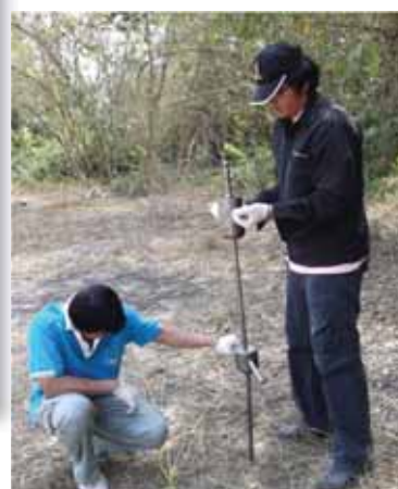
ภาพที่ 5 แสดงวิธีการใช้อุปกรณ์สำหรับตรวจสอบความแน่นของดิน
