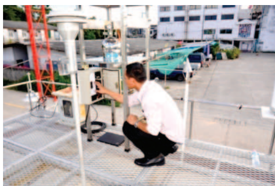
รูปที่ 2 แสดงทดสอบอุปกรณ์ตรวจวัดกลิ่นแบบอัตโนมัติ ณ บริเวณสถานีตรวจวัดคุณภาพอากาศ
