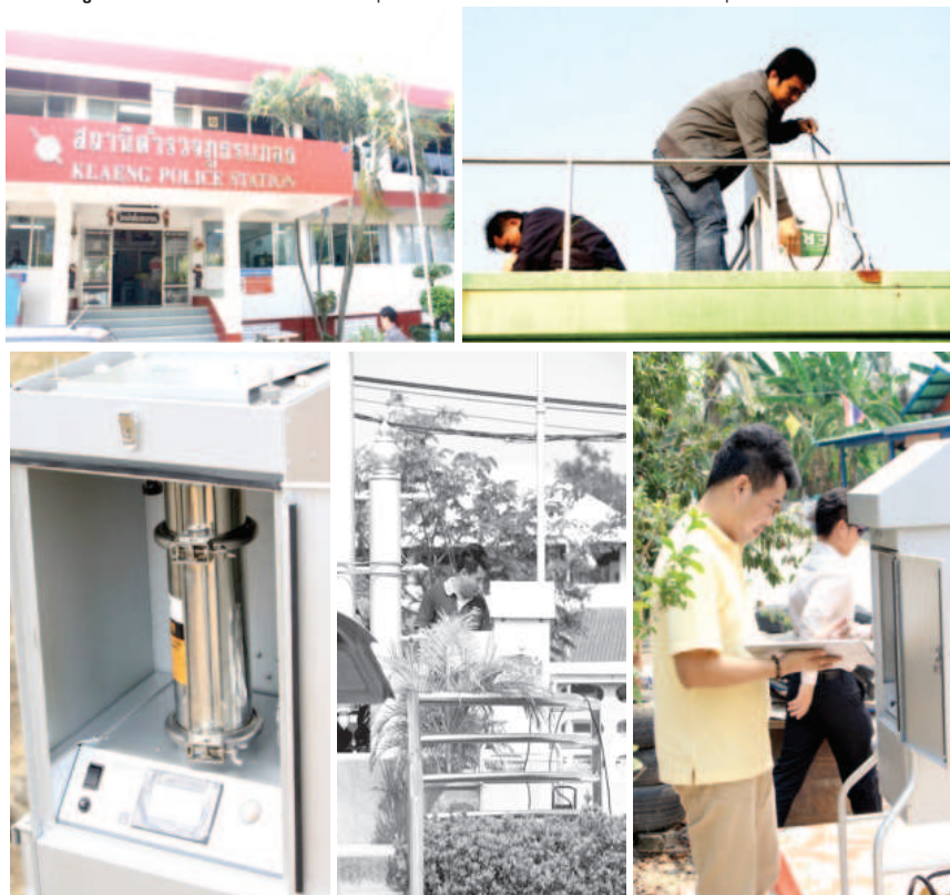
รูปที่ 4 แสดงการติดตั้งอุปกรณ์เก็บตัวอย่างอากาศบริเวณพื้นที่จังหวัดระยองและจังหวัดสมุทรปราการ
