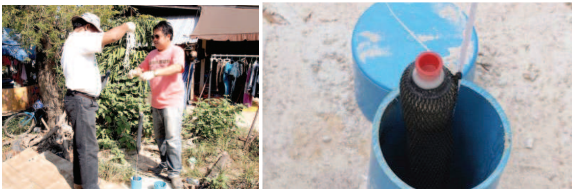
รูปที่ 2 แสดงการเก็บตัวอย่างน้ำแบบ multi-level sampling โดยใช้ diffusion sampler
